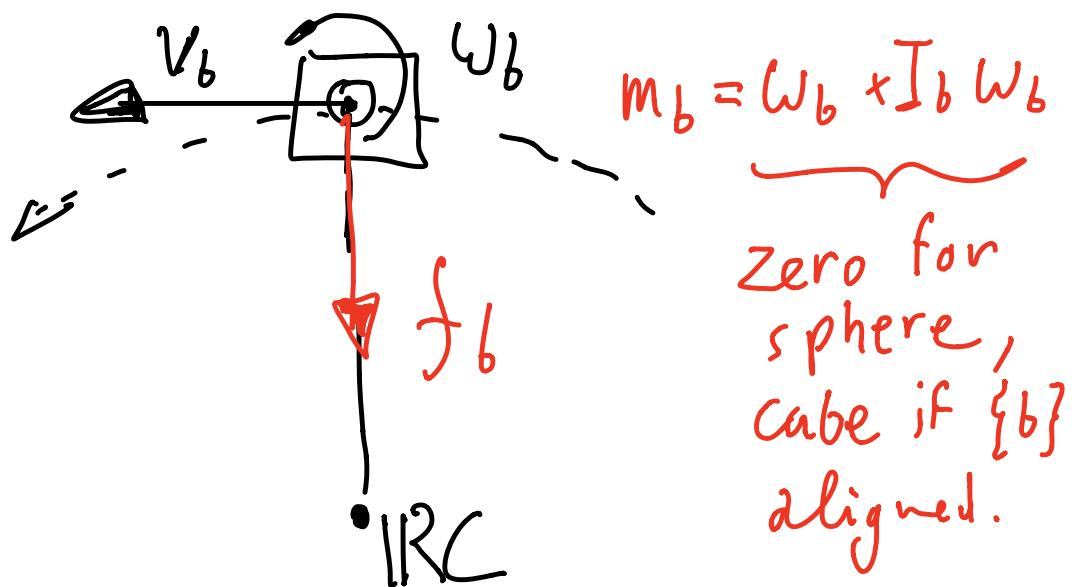
$$\begin{bmatrix} m_b \\ f_b \end{bmatrix} = \begin{bmatrix} I_b & mI \\ 0 & mI \end{bmatrix} \begin{bmatrix} \dot{\omega}_b \\ \dot{v}_b \end{bmatrix} - \begin{bmatrix} \hat{\omega}_b \\ \hat{v}_b \hat{\omega}_b \end{bmatrix}^T \begin{bmatrix} I_b & mI \\ 0 & mI \end{bmatrix} \begin{bmatrix} \omega_b \\ v_b \end{bmatrix}$$
